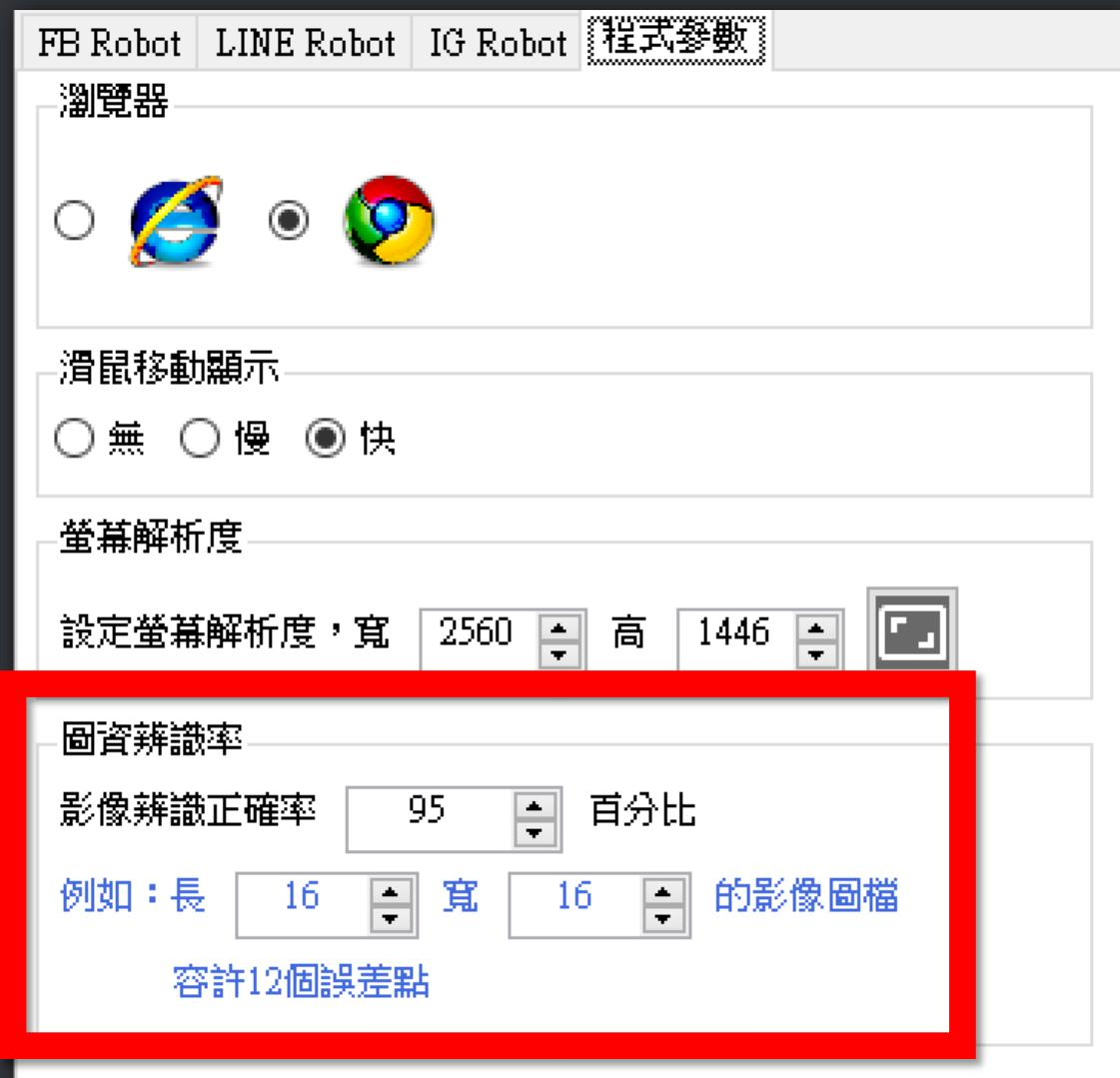
您也可以將影像辨識正確率調整為 95%，可解決因瀏覽器重開時渲染造成圖資些微差異現象。
